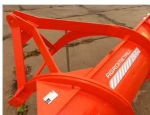
Zesílené provedení zadní sněhové radlice 02
