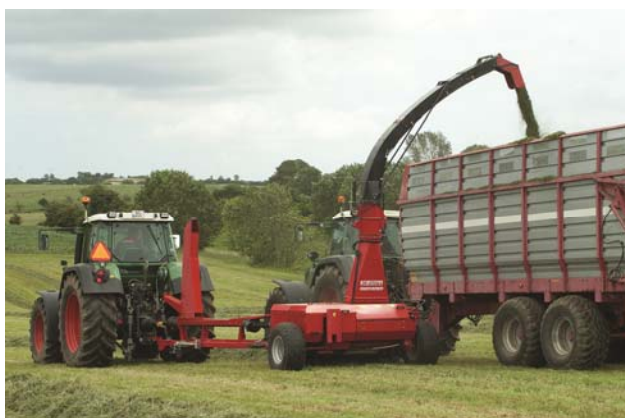
FCT 1060 ProTec s hydraulicky sklopným komínem
